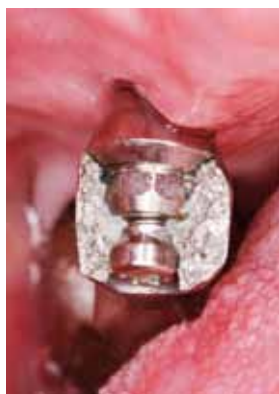
Abb. 6 Fraktur einer gusstechnisch gefertigten Steggeschiebe-Konstruktion im Bereich der Extension.
