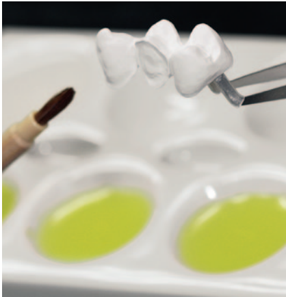
Abb. 10 Die Einfärbelösungen mit unterschiedlichen Farbintensitäten werden im vorgesinterten Zustand mit einem Pinsel aufgetragen
